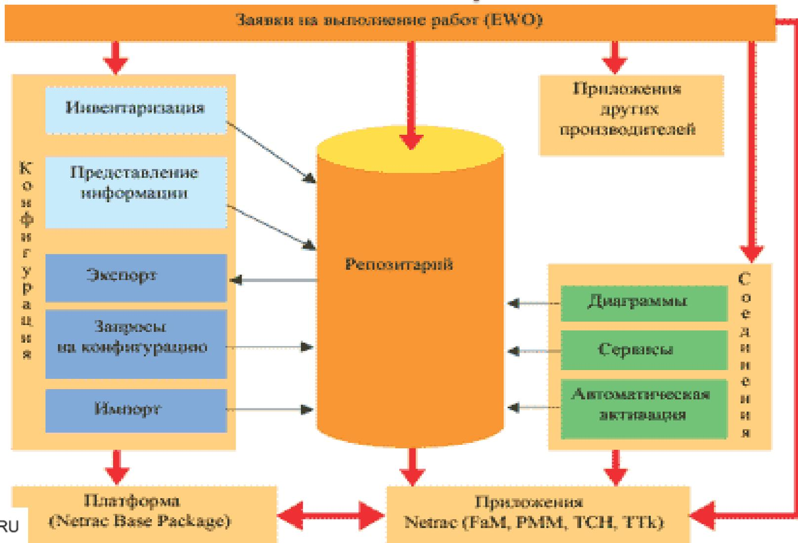
**Блок для выполнения динамических операций конфигурирования устройств в реальном режиме времени Configuration and Provisioning** выполняет функции инвентаризации устройств в сети, обработку запросов технических служб, поступающих из модуля, а также функции программирования соединений и автоматической активации сетевых элементов.
